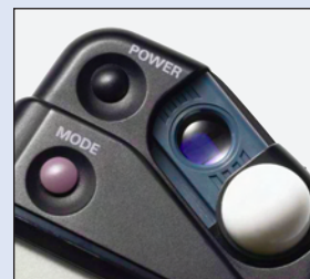
Light receptor 2 (lens)
